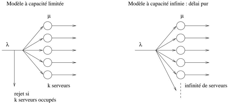
FIGURE 1 – Modèle des systèmes de ressources sans buffer à capacité finie (rejet) ou infinie
