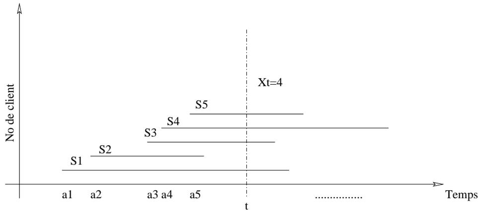
FIGURE 5 – Exemple de comportement de la  $M/GI/\infty$ , le trait horizontal de longueur  $S_i$  représente la présence du client  $i$  dans le système
